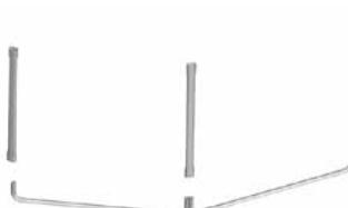
3. Iniziare l'assemblaggio della struttura inserendo i pali ovali verticali verniciati **B** nei pali inferiori.
