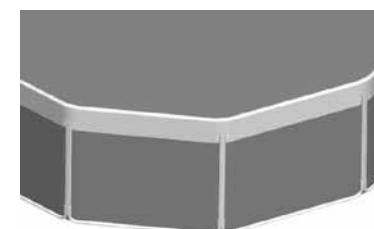
8. Les extrémités incurvées des tubes supérieurs doivent ensuite être insérer dans les trous situés en partie haute des tubes ovales montés précédemment sur la structure.
