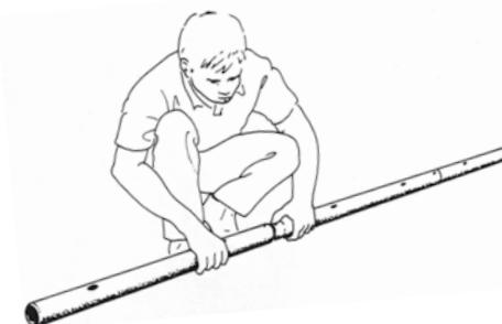
3. Montage der Stangen: Jede Stange besteht aus zwei Endstücken (**A** und **C**) und der entsprechenden Anzahl von Zwischenstücken (**B**), die für die Länge, bzw. Breite des Schwimmbeckens notwendig sind.
