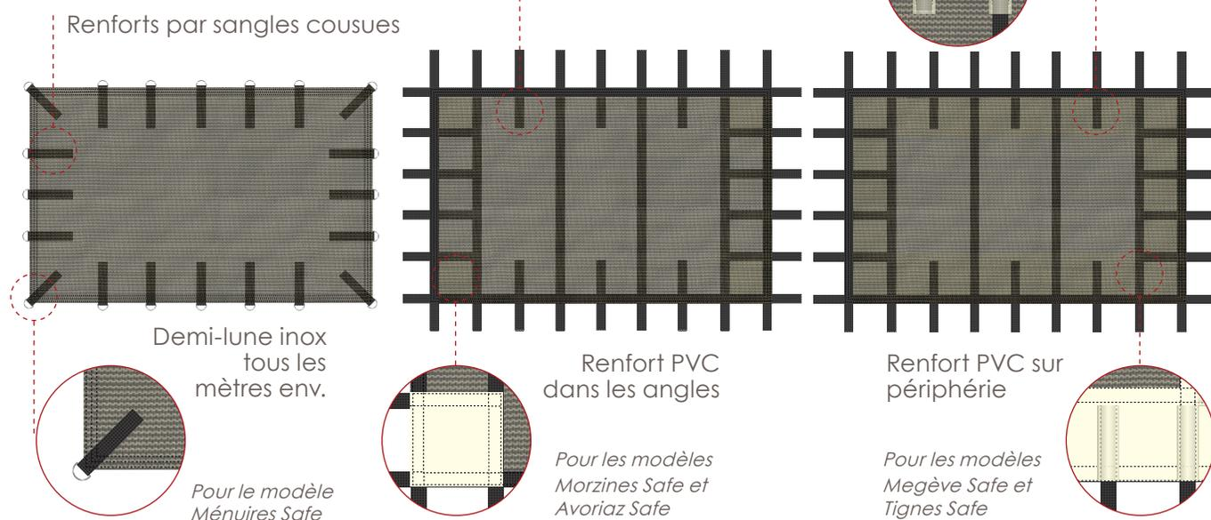
Les couvertures d'hivernage de sécurité filtrantes sont conçues à partir d'un filet en polypropylène tissé 150 g/m<sup>2</sup> traité anti-UV et imputrescible, et assemblée par couture en fil polyester. Débordement de 35 cm sur les côtés de la couverture pour des bassins inférieurs ou égaux à 70 m<sup>2</sup>. Débordement de 40 cm sur les côtés de la couverture pour des bassins supérieurs à 70 m<sup>2</sup>.
