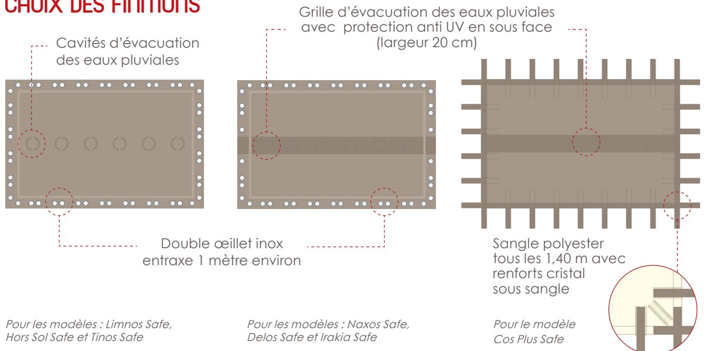
Les couvertures d'hivernage de sécurité opaques sont conçues à partir de tissu enduit PVC 580 g/m<sup>2</sup> traité anti-UV et anti-cryptogamique avec finition vernie. Elles sont dotées de cavités ou d'une grille pour l'évacuation des eaux pluviales selon le modèle avec protection anti-UV en sous face.
