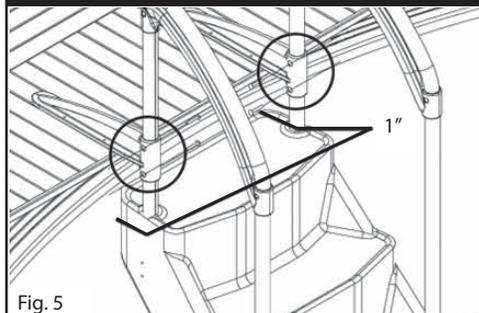
6. Glissez les bras de support de façon à ce qu'ils soient appuyés sur la plate-forme. Fixez le tout avec les vis 3/4" (4) fournies. Voir la partie encerclée (Fig. 5)
