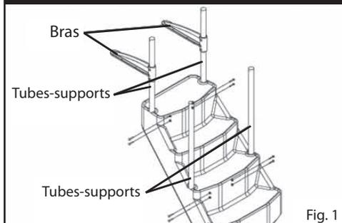
1. Insérez les tubes-supports dans les orifices prévus. Alignez les trous et fixer le tout au moyen des boulons 3" (8), rondelles (16) et écrous (8) fournis. Faire glisser les bras de support sur les tubes localisés au haut de la marche sans les boulonner. (Fig. 1)
