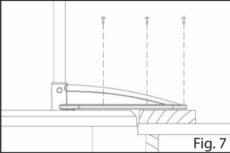
8. Si la plate-forme est plus basse que le siège, utilisez un bloc-espaceur\* pour obtenir le même niveau (Fig. 7). Assurez-vous que le bloc-espaceur\* soit bien fixé sur la plate-forme.
