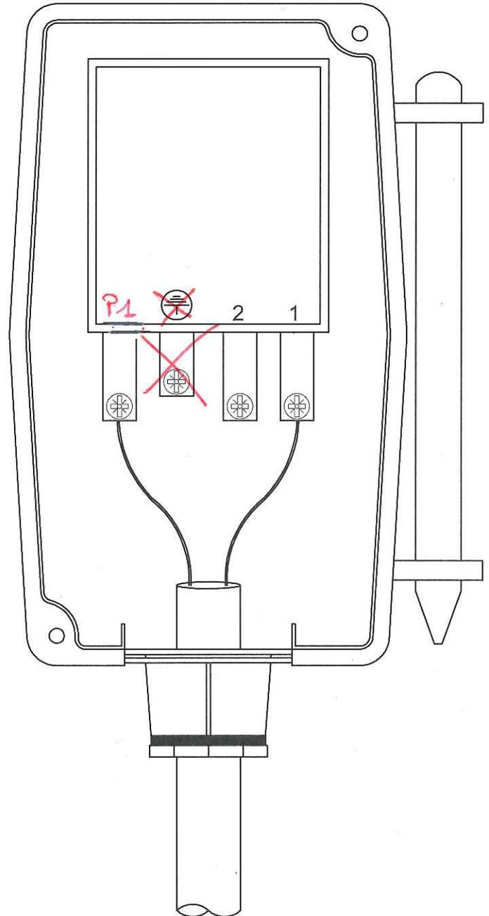
Raccordez les fils aux bornes ( C - 1 )
